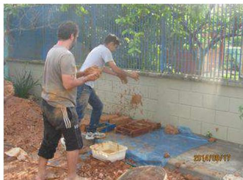
Depois da forma preenchida com a massa, é necessário se realizar o acabamento do tijolo, com a mão bem úmida. Após esse processo, a retirada da forma deve ser rápida e de maneira que os lados da forma fiquem alinhados.
