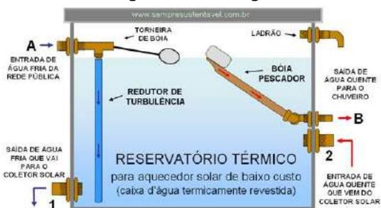
Realizar cinco furos; para a entrada de água fria (A), saída de água para as placas (1), saída de água para utilização (B), o retorno da água das placas (2) e o furo para a saída do excesso de água (ladrão).
